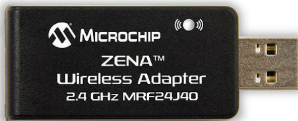
Slika 14: ZENA USB adapter kompanije Mikročip.
