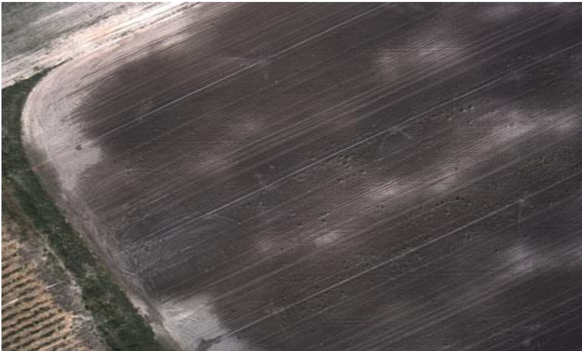
Anexa 4. Localizarea lacunele de irigații pentru un câmp din vestul Nipissing, Canada. Imaginea captată la 120 m înălțime, folosind un Aeryon Scout UAS. zonele uscate, adică lipsite de acoperire, sunt prezentate în ton luminos. [33]
