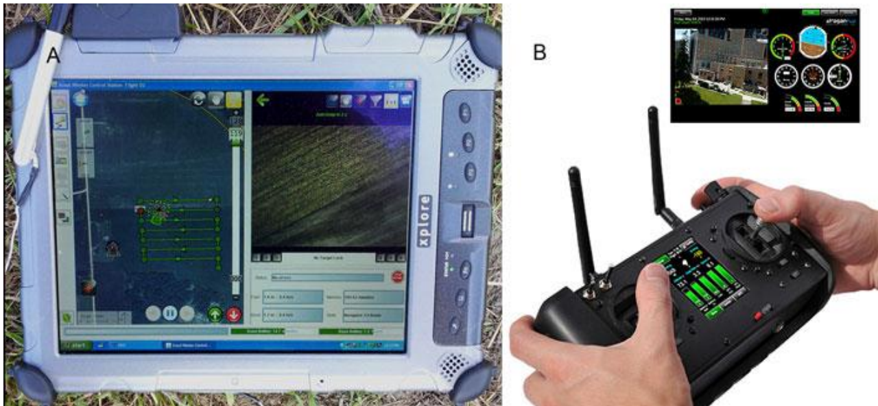
Anexa 3. Exemple de stații de control UAS: o stație de comandă pentru Aeryon Scout UAS (A), controler pentru UAS Draganflyer X8 (B). [33]
