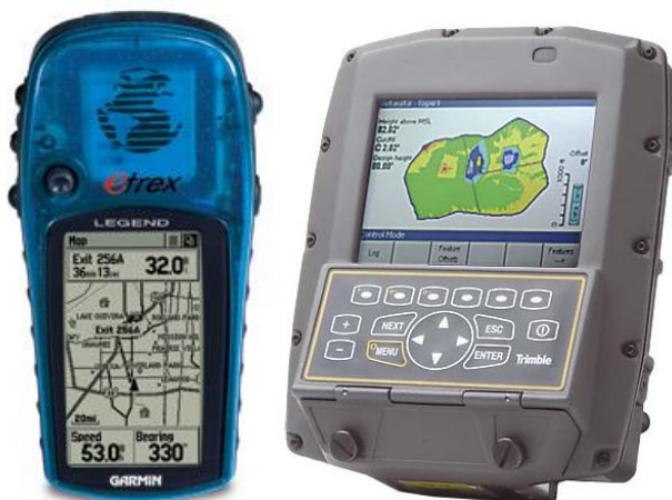
Fig. 3.1. Receptorul GPS eTrex Legend (stânga) și calculatorul portabil Trimble AgGPS®170 (dreapta)
